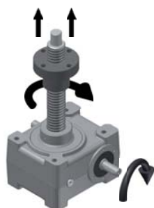
Martinetti con Vite senza fine destra e stelo destro. Right handed wormscrew and lead screw.
